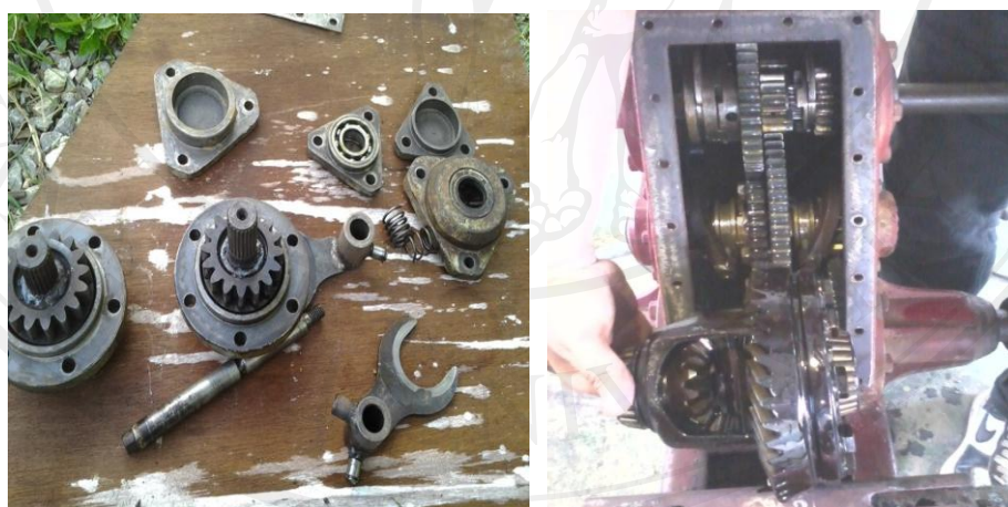
รูปที่ ค2. ชิ้นส่วนเกียร์รถไถเดินตามที่ประกอบเป็นห้องเกียร์รถแทรกเตอร์ขนาดเล็ก
