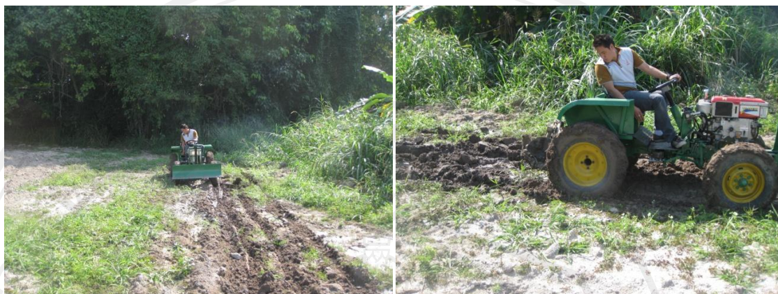
รูปที่ ค13. การทดสอบประสิทธิภาพการทำงานในพื้นที่ของรถแทรกเตอร์ขนาดเล็ก
