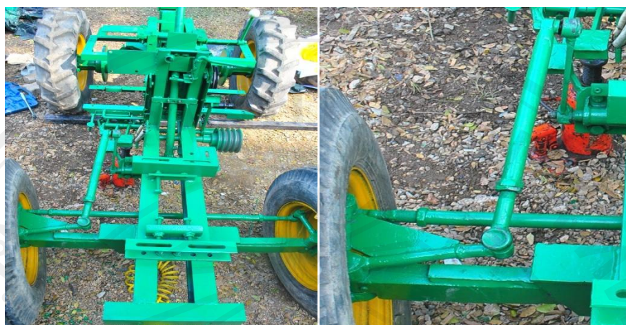
รูปที่ ค3. โครงรถแทรกเตอร์ขนาดเล็ก
