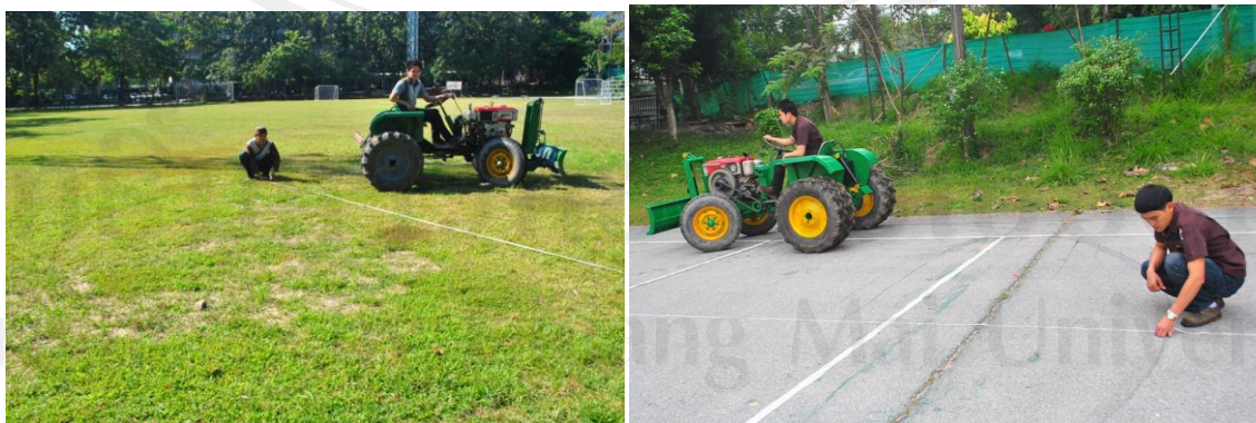
รูปที่ ค12. การวัดวงเลี้ยวของรถแทรกเตอร์ขนาดเล็ก
