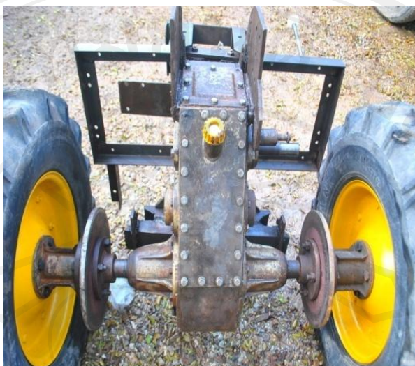
รูปที่ ค1. เกียร์รถไถเดินตามที่ประกอบเป็นรถแทรกเตอร์ขนาดเล็ก
