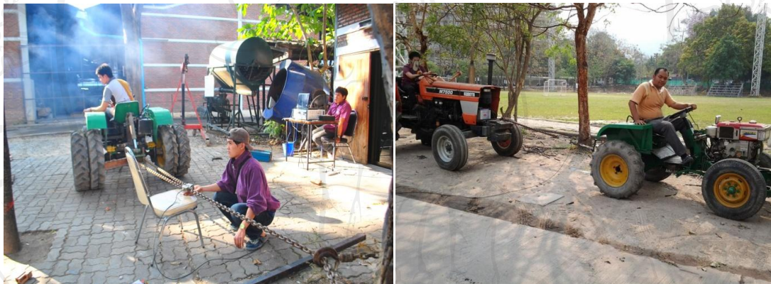
รูปที่ ค11. การทดสอบแรงฉุดลากของรถแทรกเตอร์ขนาดเล็ก
