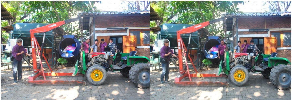
รูปที่ ค9. การทดสอบการชั่งน้ำหนักโดยใช้สแตนด์ของรถแทรกเตอร์ขนาดเล็ก
