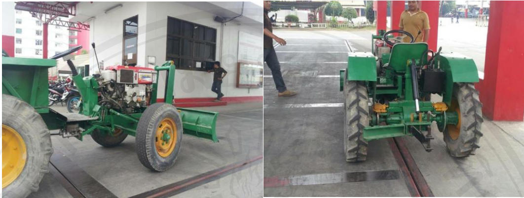
รูปที่ ค10. การทดสอบการชั่งน้ำหนักโดยใช้เครื่องชั่งน้ำหนักของรถแทรกเตอร์ขนาดเล็ก
