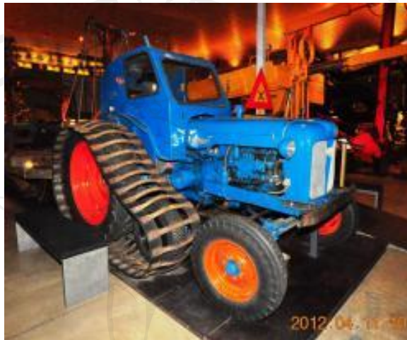
รูปที่ 2.2 รถแทรกเตอร์แบบกึ่งล้อตะขาบ
