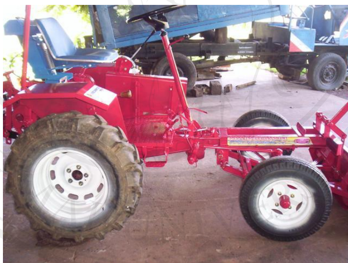
รูปที่ 2.4 โครงสร้างรถแทรกเตอร์ขนาดเล็ก
