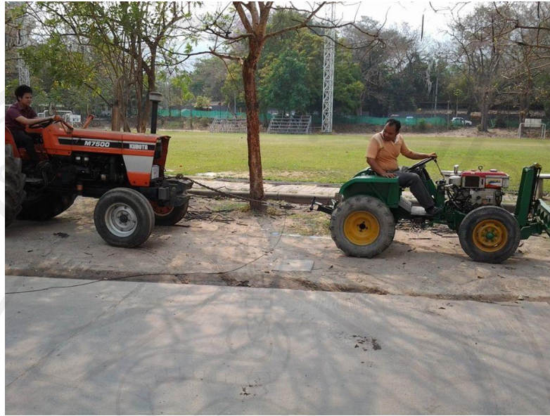
รูปที่ 4.10 แสดงการทดสอบสมรรถนะการฉุดลากของรถแทรกเตอร์
