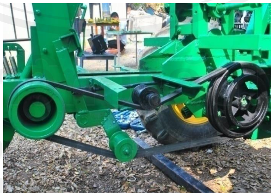
รูปที่ 4.7 ระบบตัดต่อกำลัง
