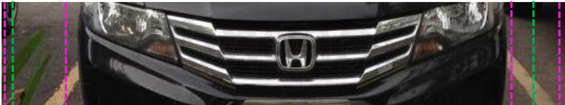
ภาพที่ 5.5 ขอบเขตในการพิจารณาขอบซ้าย-ขวาของหน้ากระจังและตำแหน่งขอบซ้ายและขวาของหน้ากระจัง
