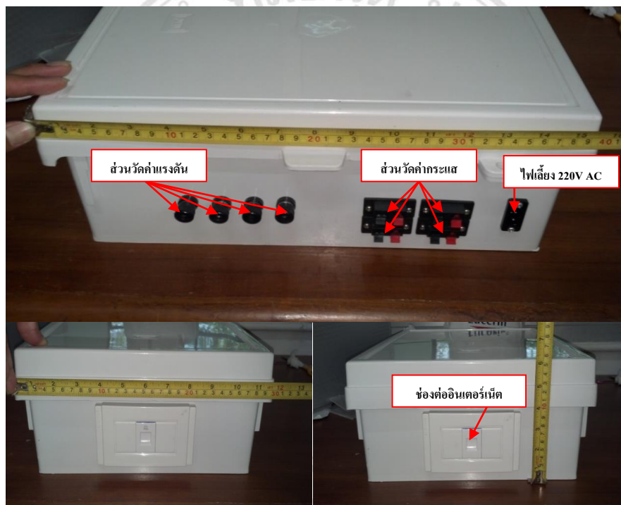
รูปที่ ง.1 กล่องระบบตรวจวัดพลังงานไฟฟ้าผ่านอินเทอร์เน็ตและจุดเชื่อมต่ออุปกรณ์ภายนอก
