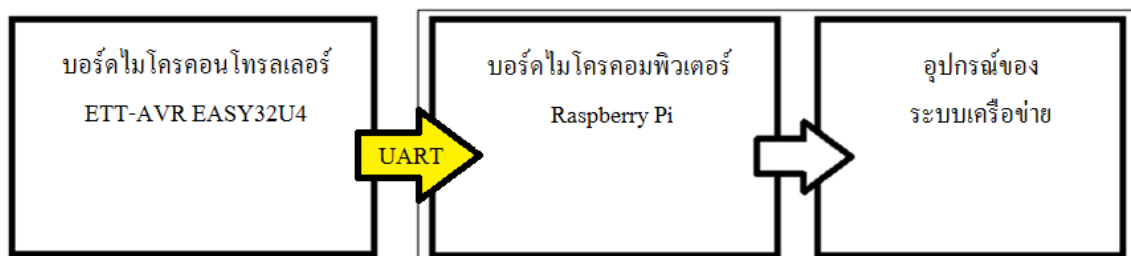
รูปที่ 3.9 การเชื่อมต่ออุปกรณ์ระหว่างส่วนวัดค่าทางไฟฟ้าและส่วนตัวบริการเว็บ
