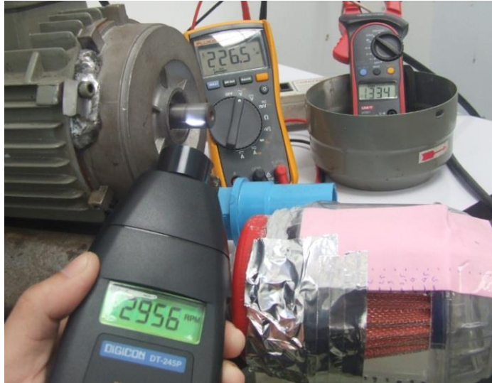
รูปที่ 3.23 การทดลองสภาพอุณหภูมิของตัวกรองอากาศที่มีผลต่อความต้องการกำลังไฟฟ้า
