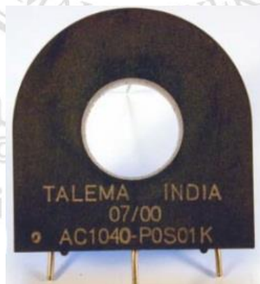
รูปที่ 3.3 เซนเซอร์วัดกระแสไฟฟ้ายี่ห้อ TALEMA รุ่น AC1040
