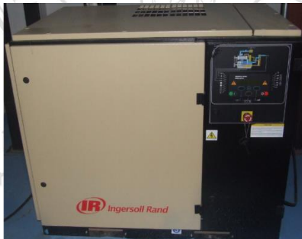
รูปที่ 3.24 เครื่องอัดอากาศชนิดสกรูยี่ห้อ Ingersoll Rand รุ่น U18-8
