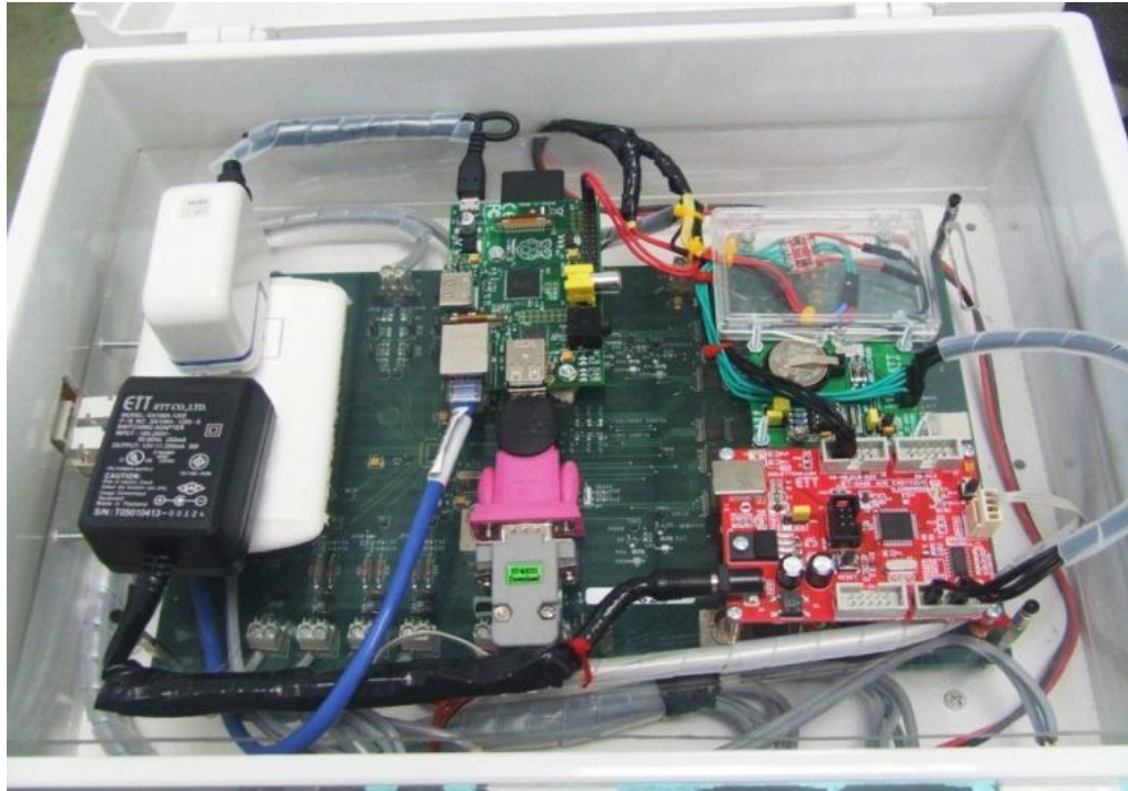
รูปที่ 3.10 การประกอบอุปกรณ์ลงในกล่องพลาสติกด้านใน
