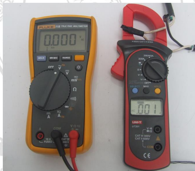
รูปที่ 3.22 มิเตอร์วัดแรงดันไฟฟ้า และมิเตอร์วัดกระแสไฟฟ้า
