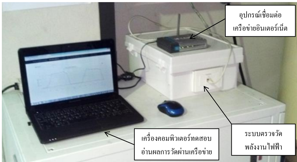
รูปที่ 3.26 ลักษณะการเชื่อมต่อสัญญาณอินเทอร์เน็ตให้กับระบบตรวจวัดพลังงาน
