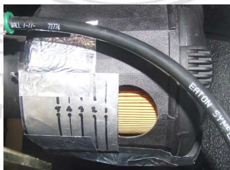
รูปที่ 4.5 ลักษณะการนำแผ่นโลหะเลื่อนปิดช่องลมเข้าที่กล่องครอบตัวกรองอากาศ
