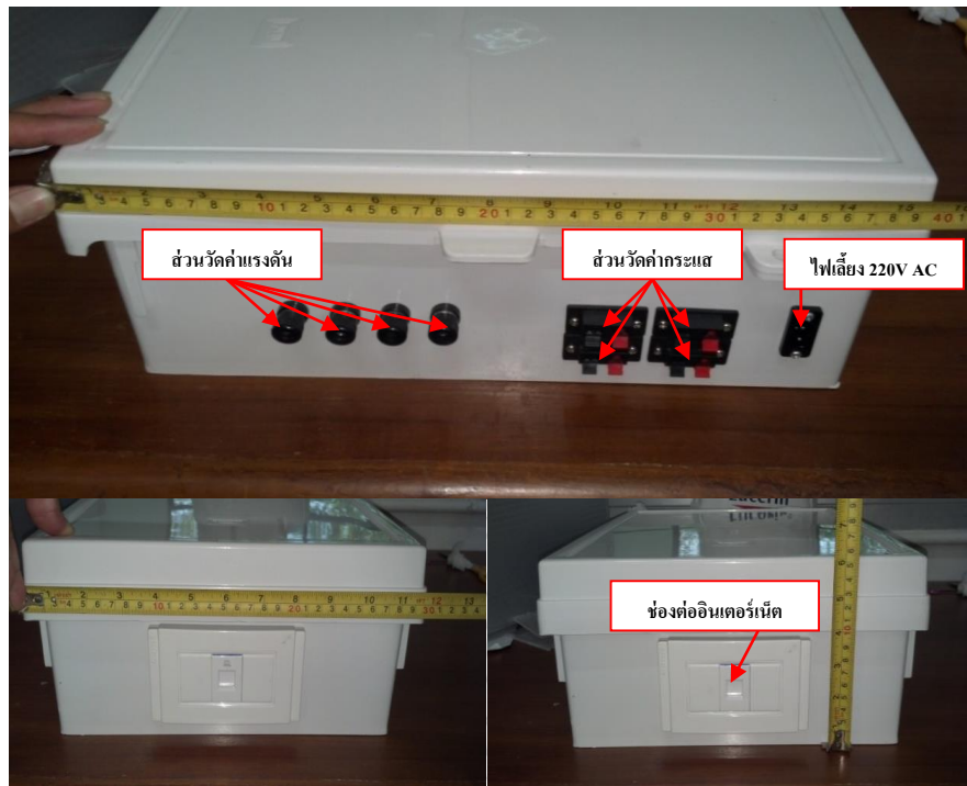
รูปที่ 4.1 กล่องระบบตรวจวัดพลังงานไฟฟ้าผ่านอินเทอร์เนตและจุดเชื่อมต่ออุปกรณ์ภายนอก
