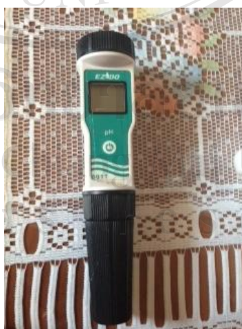
รูป 3.12 เครื่องวัดค่าพีเอชแบบพกพา EZDO 6011
