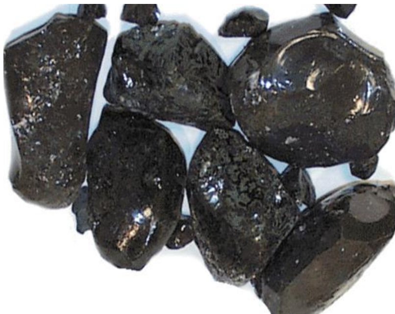
ภาพที่ 1.4 ลักษณะตะกรันที่ได้จากการหลอมเหล็ก
