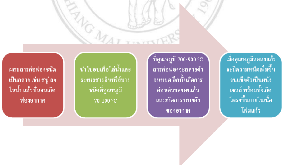
ภาพที่ 2.4 แผนผังการเกิดโฟมแก้วด้วยกระบวนการแบบเปียก
