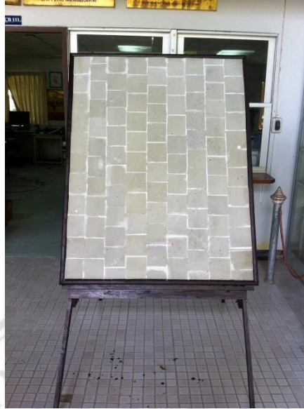
ภาพที่ 4.42 การติดตั้งบอร์ดโฟมแก้วฉนวนความร้อน
