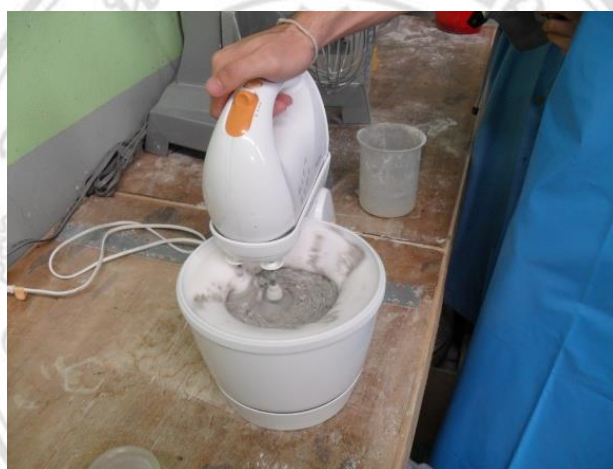
ภาพที่ 4.37 ขั้นตอนการปั่นตีฟองสบู่
