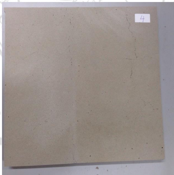
ภาพที่ 4.52 ลักษณะของบอร์ดโฟมแก้วที่เตรียมได้จากกระบวนการแบบเปียก
