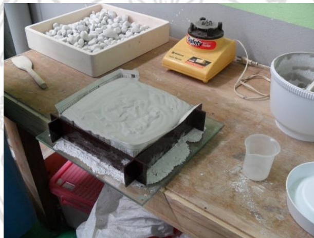
ภาพที่ 4.40 ลักษณะของสลิปโฟมแก้วที่ได้จากการปั่นผสมผงกระจกและผงตะกรัน
