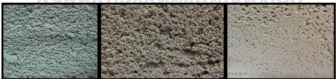
ภาพที่ 4.43 ภาพลักษณะรูพรุนของชิ้นงานที่เผาที่อุณหภูมิต่างๆ ด้วยกล้องจุลทรรศน์ (องศาเซลเซียส)
