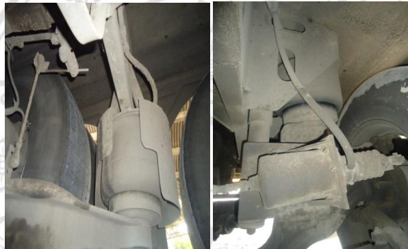
ภาพที่ ข-6 แสดงการตรวจสอบการยึดตัวของ โช้คและรอยร้าวซีมหลัง
