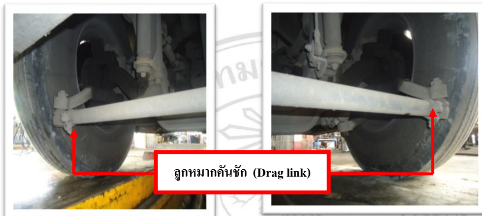
ภาพที่ ข-14 แสดงการตรวจสอบลูกหมากคันชัก (Drag link)
