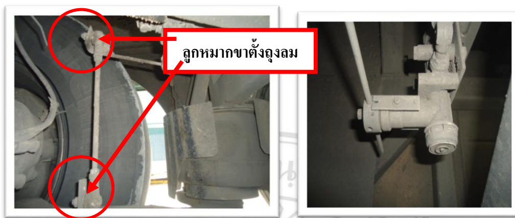
ภาพที่ ข-8 แสดงขาปรับตั้งถุงลมและลูกหมากขาตั้งถุงลม
