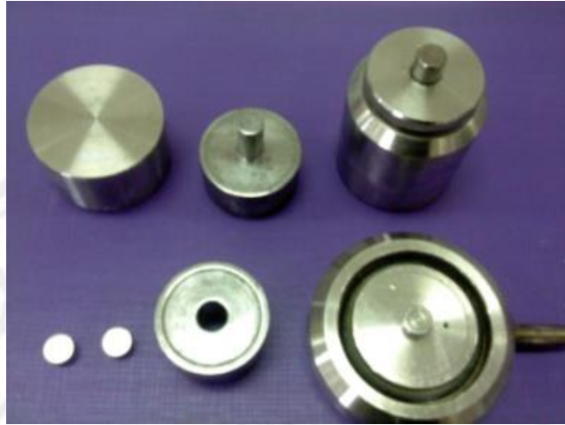
ภาพที่ 3.12 ชุดอัดขนาดเส้นผ่านศูนย์กลาง 1 เซนติเมตร
