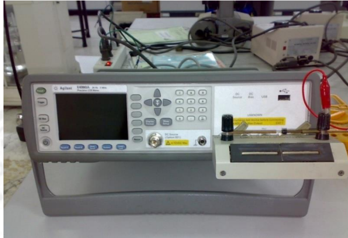
ภาพที่ 3.19 แสดงเครื่อง E4980A 20 Hz – 2 MHz Precision LCR meter
