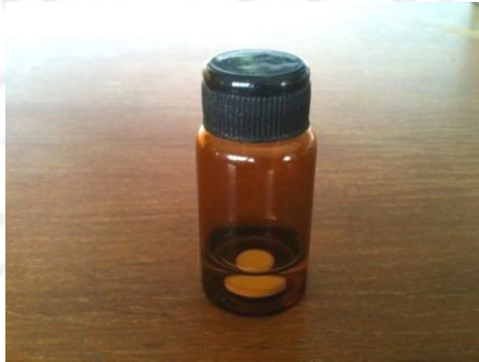
รูปที่ 3.24 แสดงการแช่เม็ดเซรามิกเบตาไตรแคลเซียมฟอสเฟตในสารละลาย SBF
