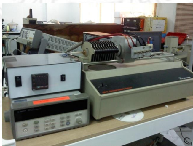
ภาพที่ 3.20 แสดงชุดควบคุมและประมวลผลเพื่อทดสอบสมบัติไดอิเล็กทริกเทียบกับอุณหภูมิ
