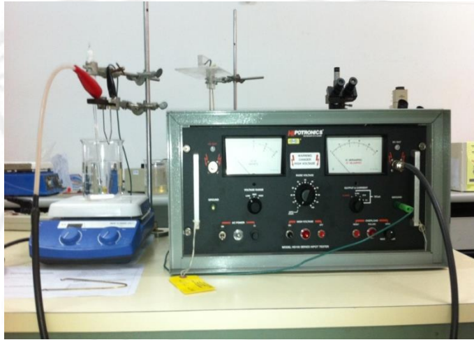
ภาพที่ 3.22 แสดงเครื่องมือในการโพลสารเซรามิก
