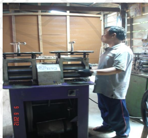
ภาพที่ 2.5 การรีดแท่งเงินด้วยเครื่องรีด
