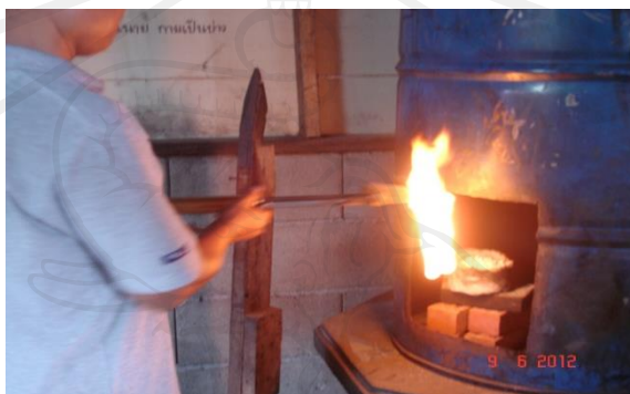
ภาพที่ 2.1 การหลอมเม็ดเงิน
