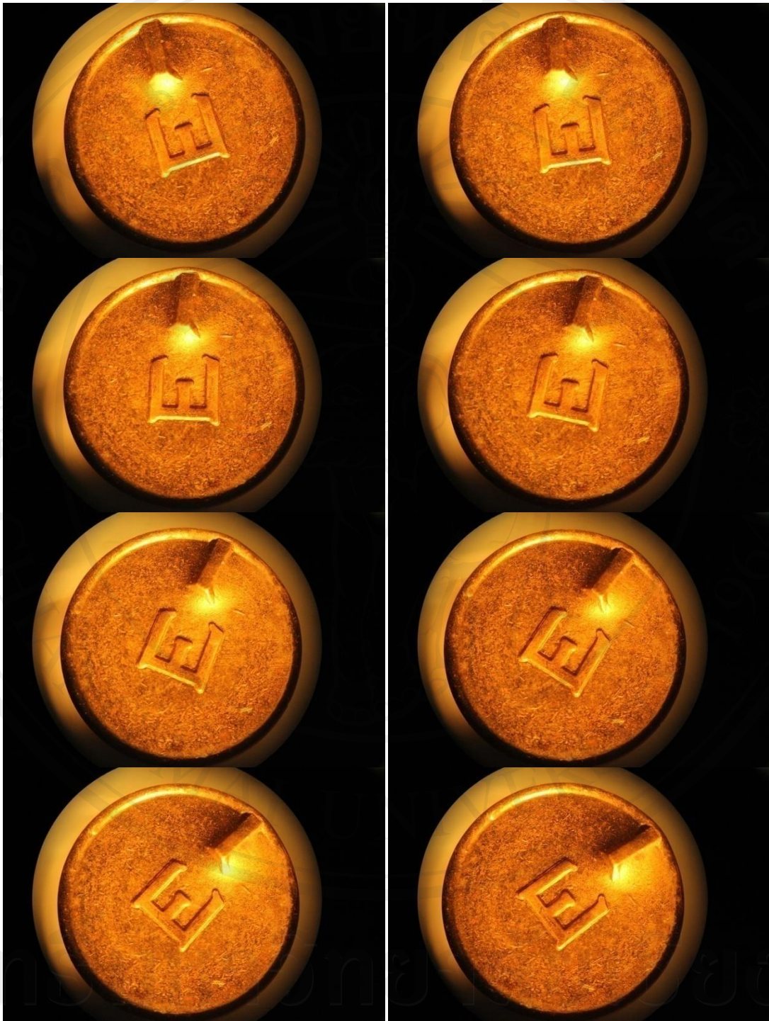
ภาพที่ 4.5 ภาพที่ได้จากการถ่ายภาพตำหนิของงานทำยปลอกกระสุนปืนขนาด .22 หมุนครบ 1 รอบ
