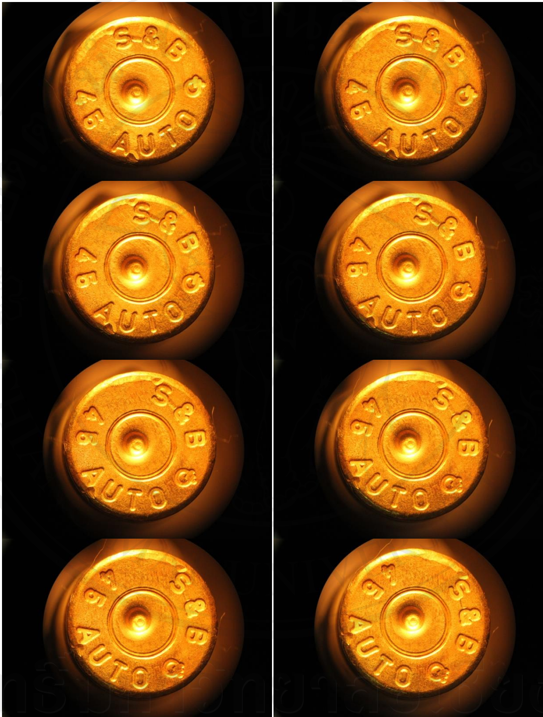
ภาพที่ 4.4 ภาพที่ได้จากการถ่ายภาพตำหนิของงานทำยปลอกกระสุนปืนขนาด .45 หมุนครบ 1 รอบ
