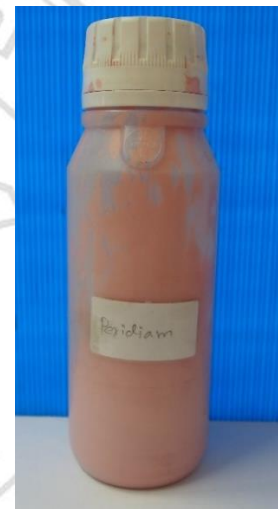
ภาพที่ 2.11 ลักษณะของสารเคลือบเมล็ดเพอริเดียม (ก.) และบรรจุภัณฑ์ (ข.)
