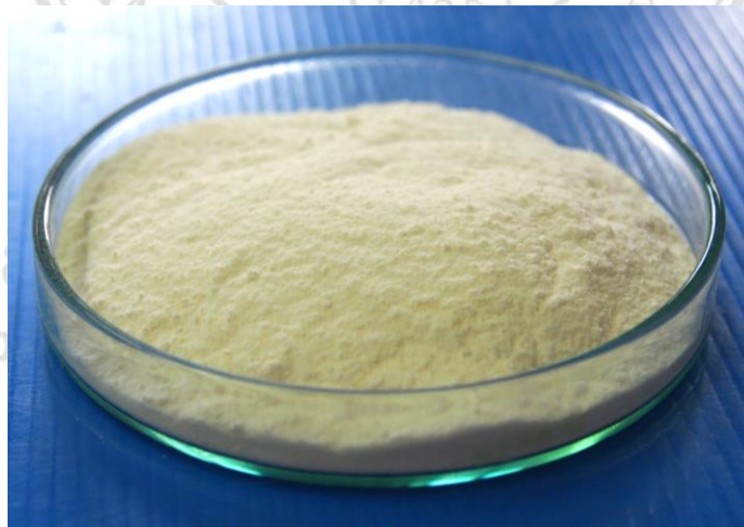
ภาพที่ 2.7 ลักษณะผงของคาร์บอกซีเมทิลเซลลูโลส (carboxymethyl cellulose, CMC)
