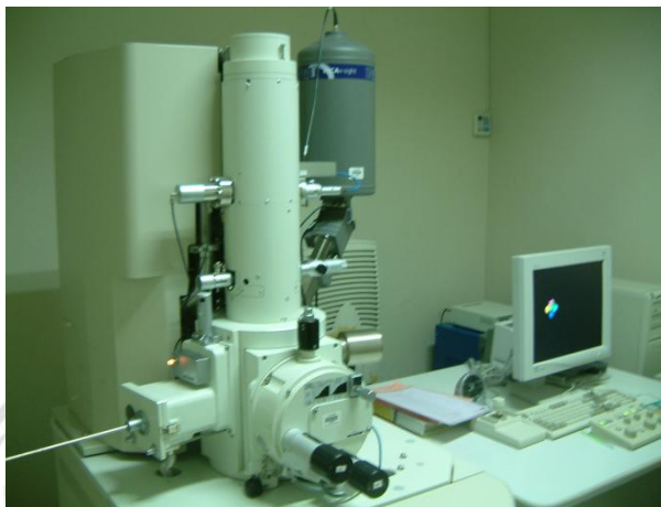
รูปที่ 3.9 แสดงกล้องจุลทรรศน์อิเล็กตรอนแบบส่องกราด (SEM)
