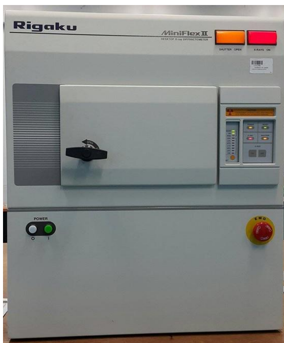
รูปที่ 3.10 แสดงเครื่องเอกซเรย์คิฟแฟร็กโทรมิเตอร์ บริษัท Rigaku รุ่น MiniFlexII
