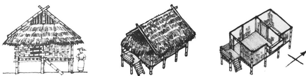
ภาพที่ 2.23: ภาพแสดงลักษณะเรือนไทใหญ่แรกสร้าง (เรือนยกพื้นต่ำแบบสามห้อง แผลดเสา) เป็นเรือนตั้งต้นสร้างครอบครัว หรือเรือนคนยากจนที่มีทุนน้อย ที่มา: ระวีวรรณ โอพารัตน์มณี (2558)
