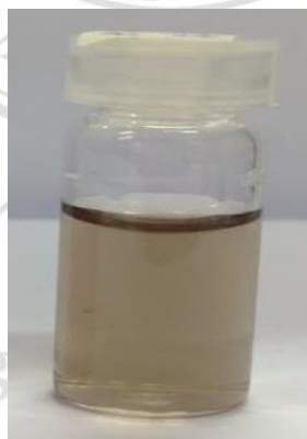
ภาพที่ 3.5 สีของสารละลายของอนุภาคนาโนแพลทินัมที่เตรียมได้
