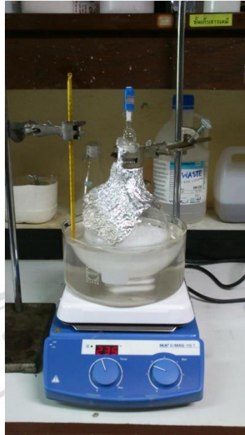
รูปที่ 3.7 อุปกรณ์ที่ใช้ในการกวนสารแลคไทด์
