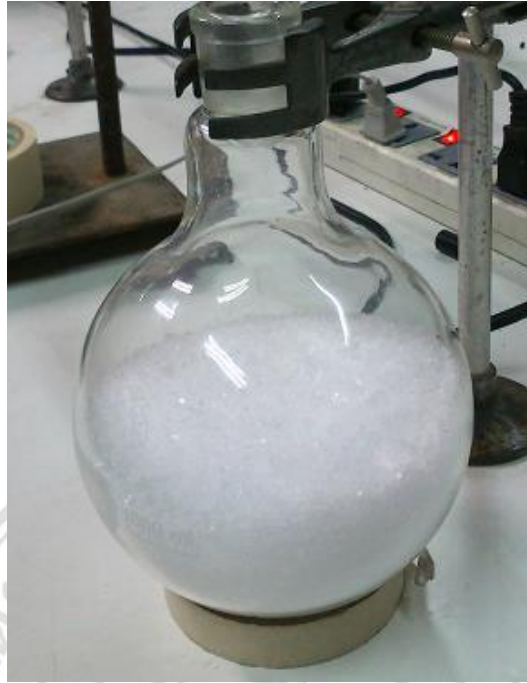
รูปที่ 4.4 ขวดชมพูที่ใช้ในการสังเคราะห์พร้อมบรรจุแคโทด
