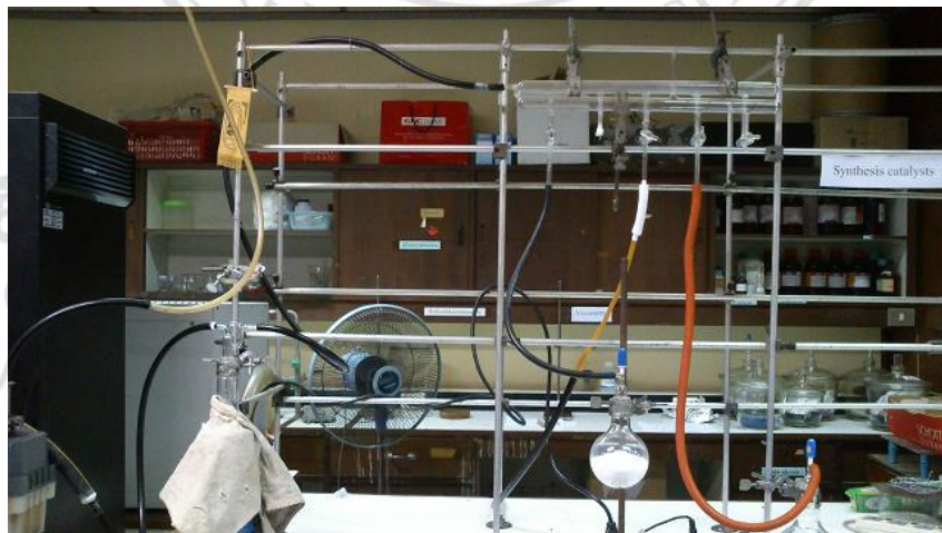
รูปที่ 4.5 การดูดอากาศภายในขวดชมพู
