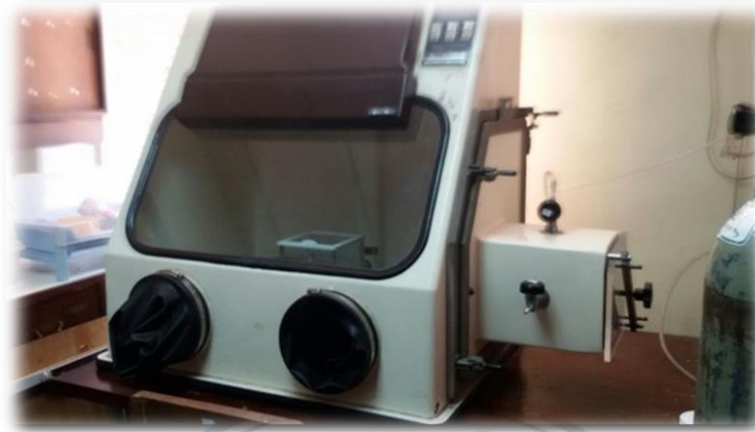
รูปที่ 4.6 ตู้สุญญากาศและตู้ควบคุมความชื้นภายใต้บรรยากาศไนโตรเจน
