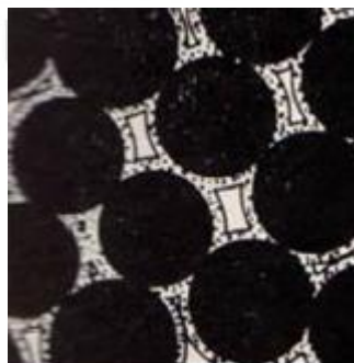
ภาพที่ 2.7 คอนกรีตไม่มีส่วนละเอียด (Andrew, S. and William, K, 1978) [15]
