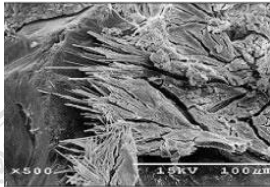
ภาพที่ 2.11 ภาพแสดงลักษณะของเอททริงไทต์ (Ettringite) (ปริญญา จินดาประเสริฐ และชัย จตุรพิทักษ์กุล, 2548) [16]
