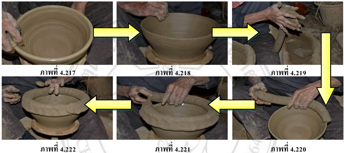
ภาพที่ 4.217 – 4.222 การติดดินเส้นเพื่อขึ้นลำตัวด้านล่างของน้ำหม้อ
