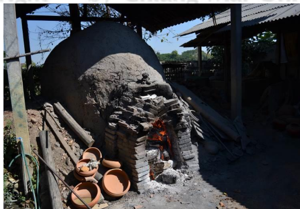
ภาพที่ 4.61 เตาเผาแบบทางเดินลมร้อนแนวนอน
