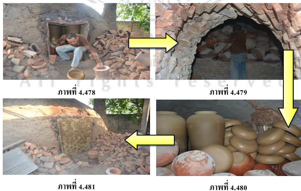
ภาพที่ 4.478 – 4.481 การปิดช่องใส่เตาเครื่องปั้นดินเผาสำหรับเตาเผาทางลมร้อนแนวนอน
