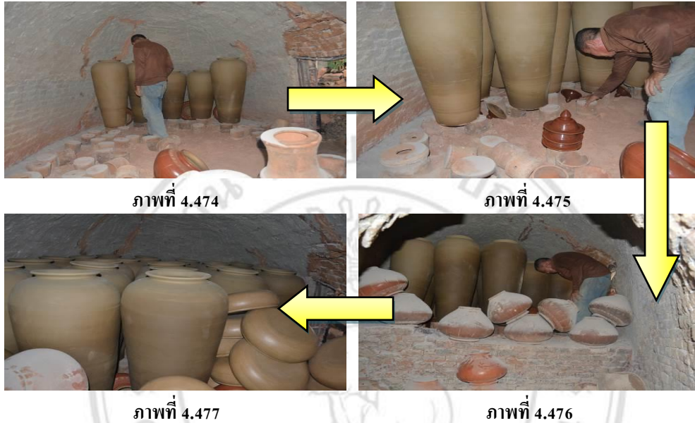
ภาพที่ 4.474 – 4.477 การวางเครื่องปั้นดินเผาลงในเตาเผาทางลมร้อนแนวนอน
