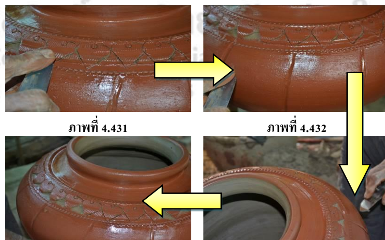
ภาพที่ 4.431 – 4.434 การใช้อุปกรณ์ “แกะลาย” แกะลายบ่าน้ำหม้อ
