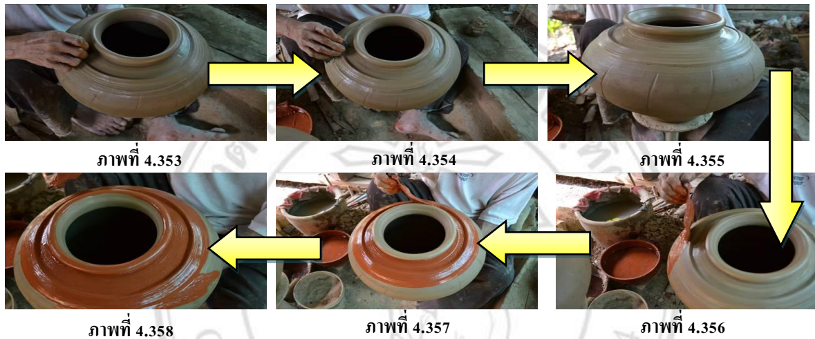
ภาพที่ 4.353 – 4.358 การทาสีขอบปากและบ่าของน้ำหม้อ
