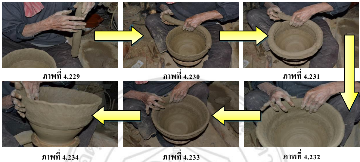
ภาพที่ 4.229 – 4.234 การขึ้นผนังดินลำตัวด้านล่างของน้ำหม้อ
