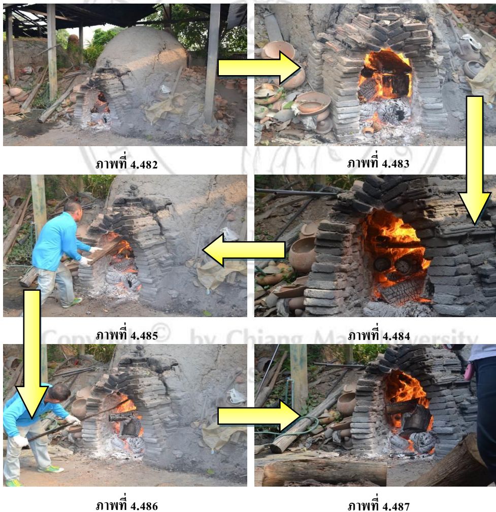
ภาพที่ 4.482 – 4.487 การจุดไฟและใส่ฟืนเตาเผาทางลมร้อนแนวนอน เพื่อทำการเผาเครื่องปั้นดินเผา
