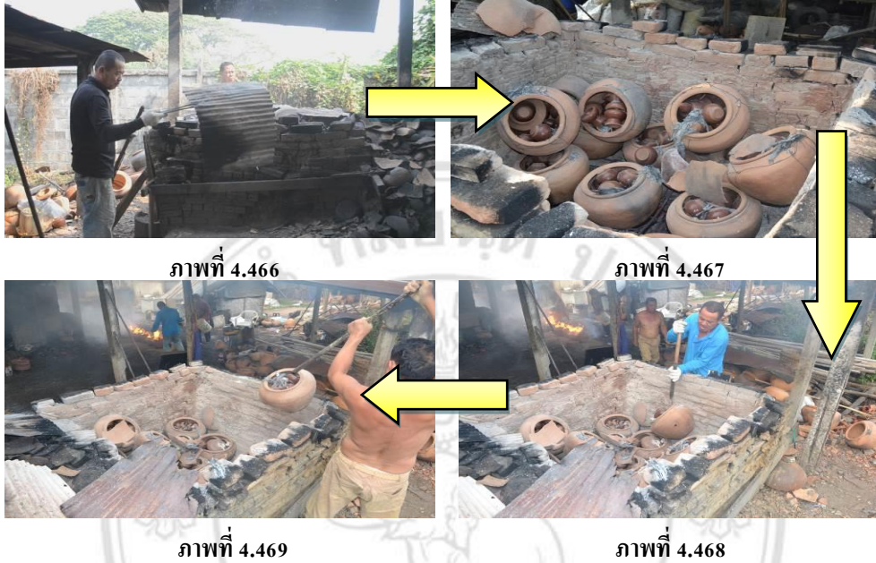
ภาพที่ 4.466 – 4.469 การนำเครื่องปั้นดินเผาออกจากเตาเผาทางลมร้อนแนวตั้ง
