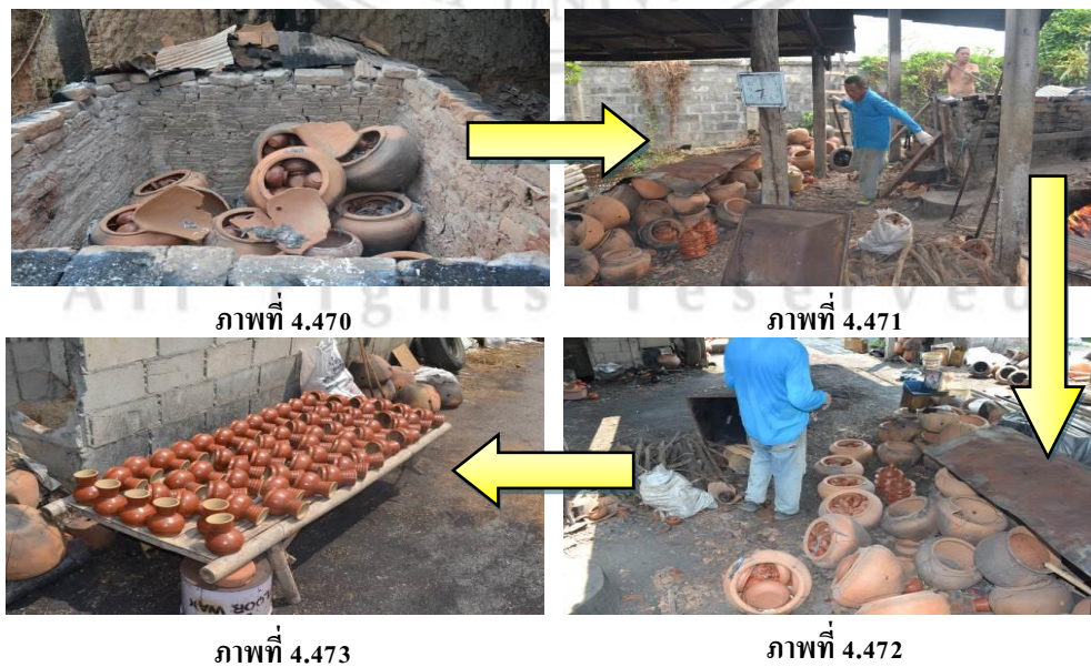
ภาพที่ 4.470 – 4.473 เครื่องปั้นดินเผาที่ผ่านการเผาจากเตาเผาทางลมร้อนแนวตั้ง
