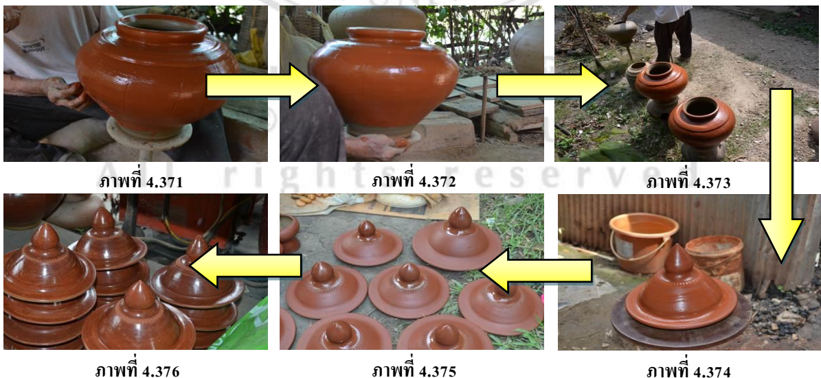
ภาพที่ 4.371 – 4.376 การตากลำตัวและฝาน้ำหม้อที่ทาสีเสร็จแล้ว
