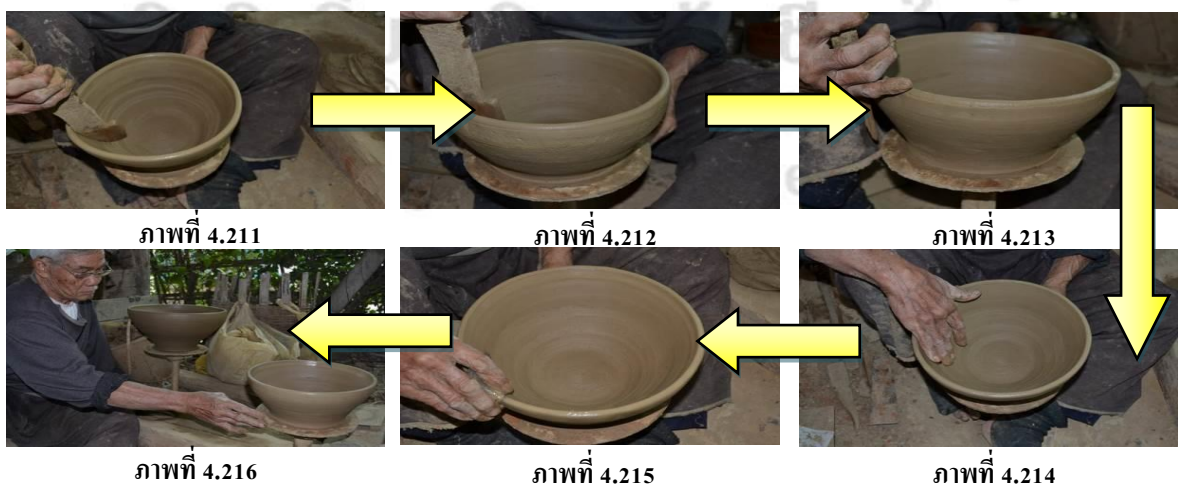
ภาพที่ 4.211 – 4.216 การขยายปากส่วนฐานของน้ำหม้อ
