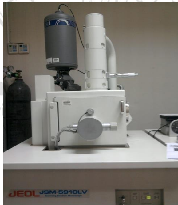
รูป 4.36 เครื่องทดสอบกล้องจุลทรรศน์อิเล็กตรอนแบบส่องกราดและการวิเคราะห์ปริมาณธาตุ
