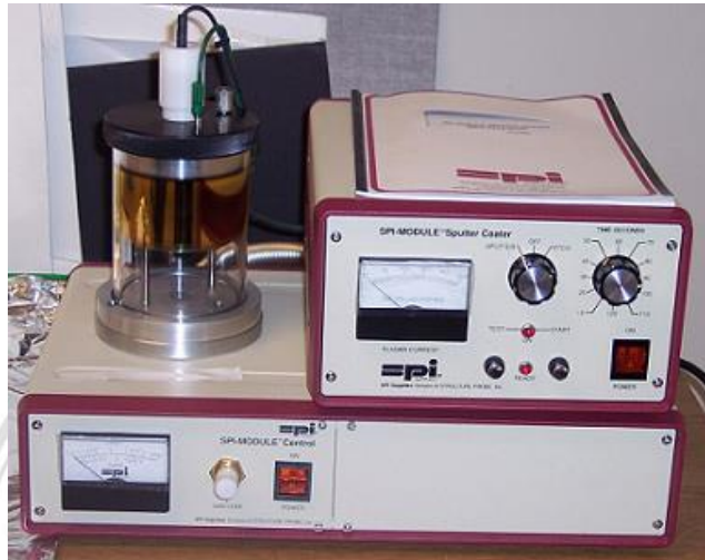
รูป 4.37 เครื่องฉาบผิวด้วยทอง (Sputter) รุ่น SPI-MODULE™ Sputter Coater
