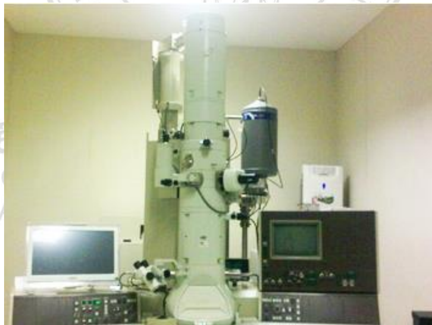
รูป 4.38 กล้องจุลทรรศน์อิเล็กตรอนแบบส่องผ่าน
