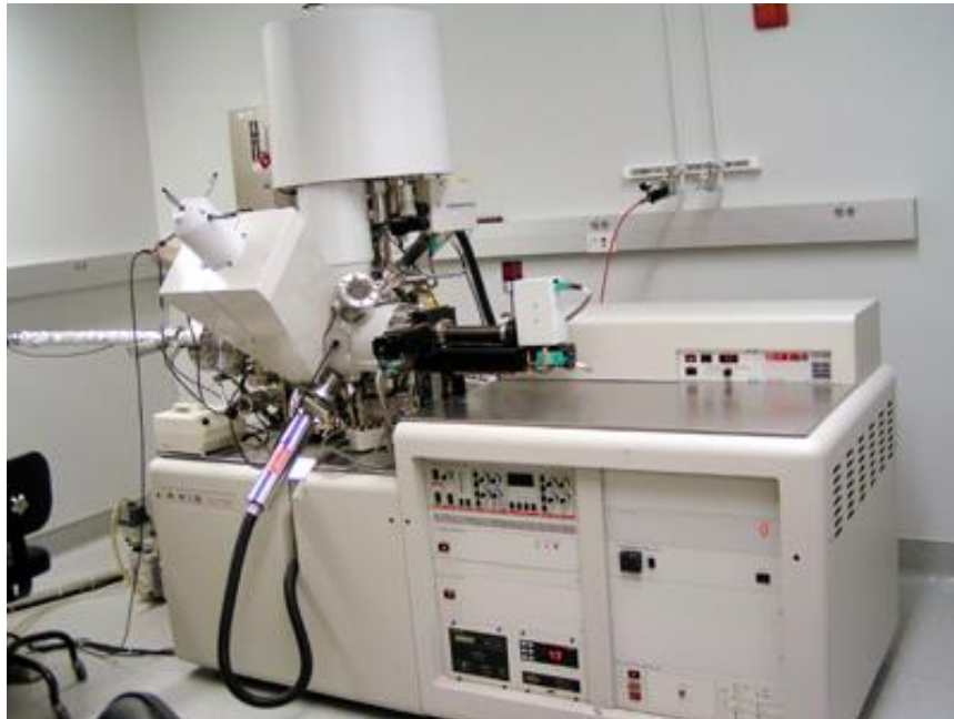
รูป 4.39 เครื่องทดสอบสเปกโทรสโกปีของอนุภาคอิเล็กทรอนิกส์ที่ถูกปลดปล่อยด้วยรังสีเอกซ์
