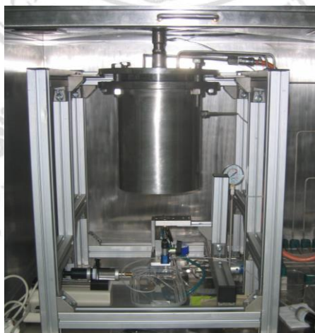
รูป 2.7 เครื่องผลิตอนุภาคนาโนความบริสุทธิ์สูงเฟลมสเปร์ย์ไฟโรลิซิสจัดตั้งที่คณะวิทยาศาสตร์ มหาวิทยาลัยเชียงใหม่
