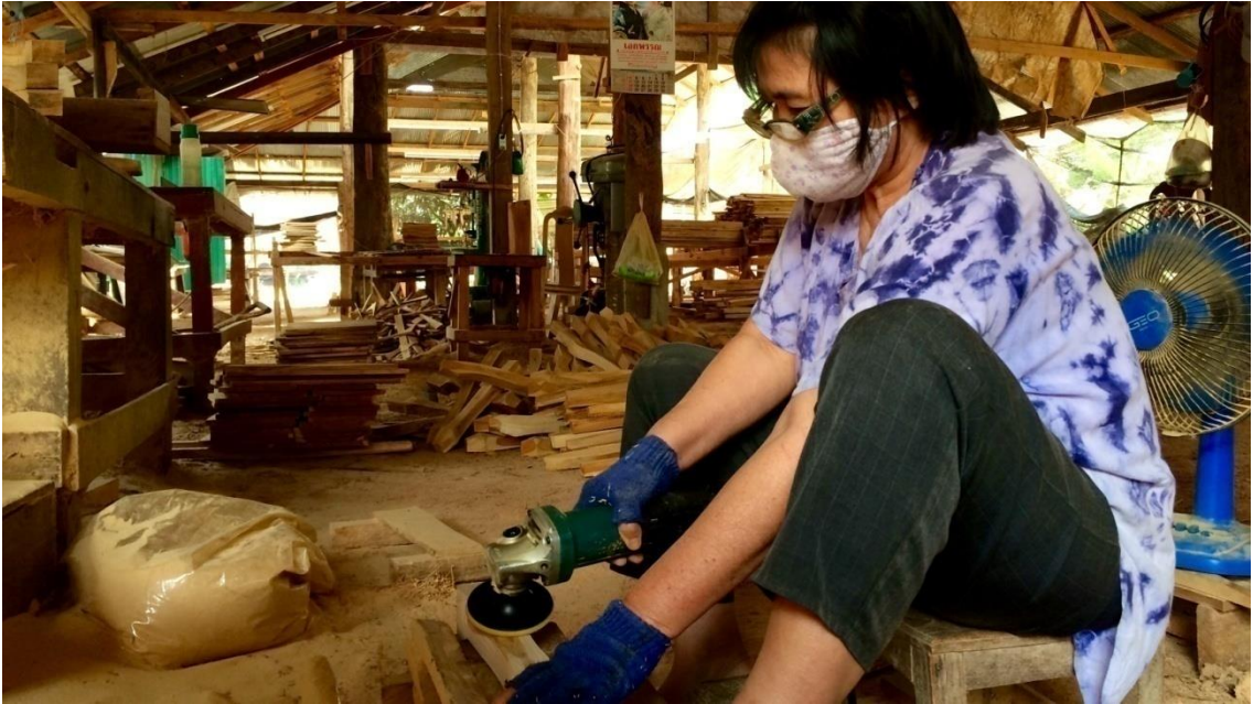
ภาพที่ 4.10 การขัดผิวขาเก้าอี้ด้วยเครื่องขัดกระดาษทรายไฟฟ้า
