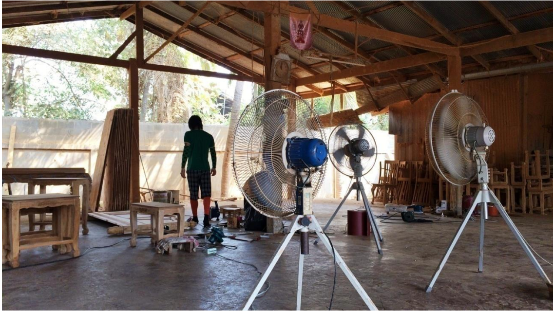
ภาพที่ 4.14 การใช้พัดลมขนาดใหญ่ในโรงงาน เพื่อเปลี่ยนทิศทางการไหลของมลพิษ ไปในทิศทางที่ไม่มีคนอาศัยอยู่
