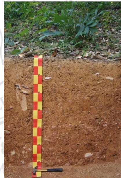
ภาพที่ 3-8 การขุดหลุมดินเพื่อศึกษาลักษณะชั้นดินและเก็บตัวอย่างดิน
