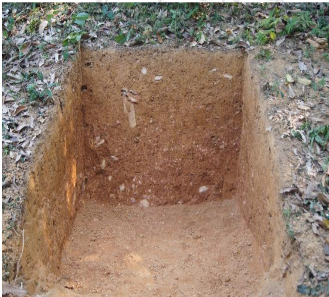
ภาพที่ 3-8 การขุดหลุมดินเพื่อศึกษาลักษณะชั้นดินและเก็บตัวอย่างดิน
