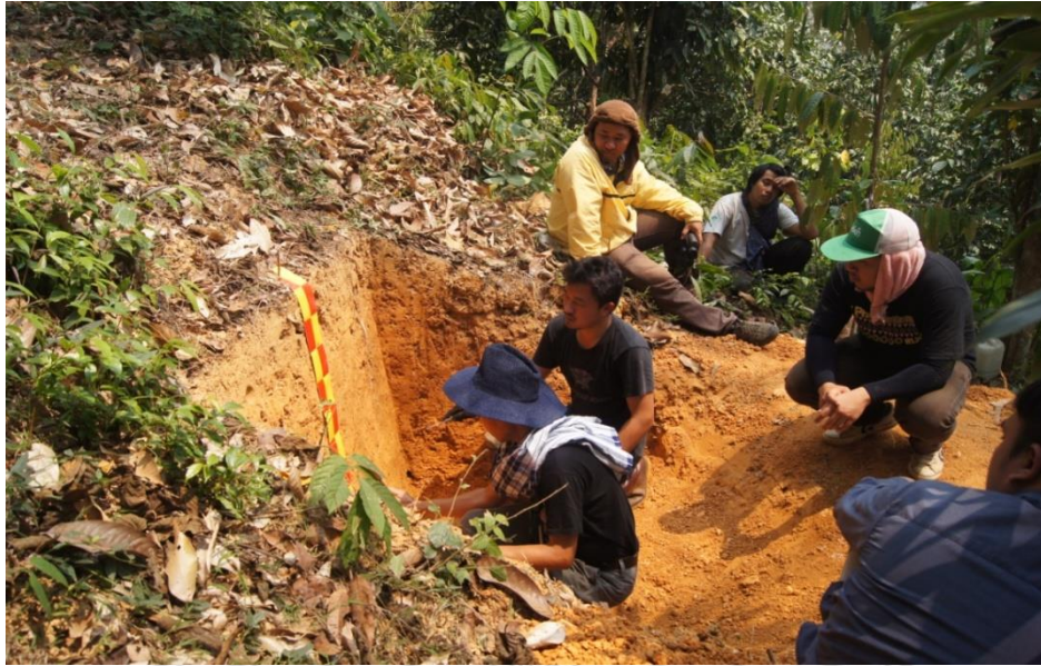
ภาพที่ 3-8 การขุดหลุมดินเพื่อศึกษาลักษณะชั้นดินและเก็บตัวอย่างดิน
