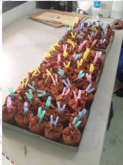
ภาพที่ 3-7 การศึกษาความจุความชื้นสนาม (Field capacity) ในห้องปฏิบัติการ
