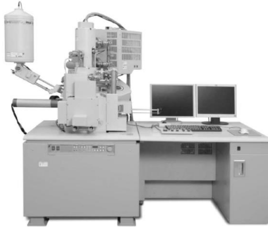
รูปที่ 2.24 แสดงลักษณะอุปกรณ์ภายนอกของกล้องจุลทรรศน์อิเล็กตรอนแบบส่องกราด (Scanning Electron microscope: SEM) [42]
