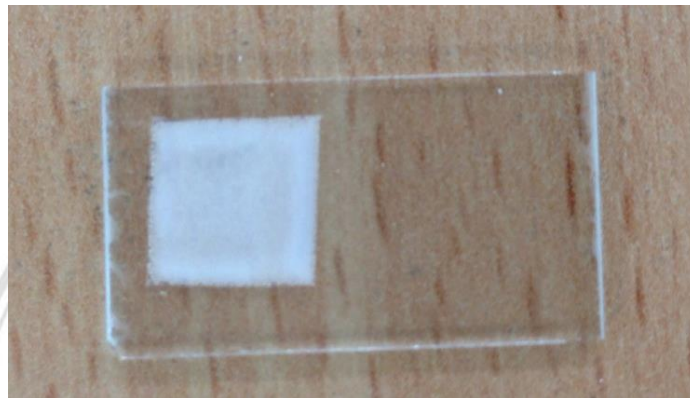
รูปที่ 3.7 อนุภาคนาโน \text{TiO}_2 + \text{PVA} ที่เคลือบฟิล์มบางบนกระจก FTO
