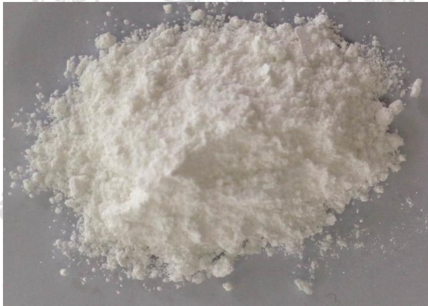
รูปที่ 3.3 ลักษณะของผง \text{TiO}_2 จากการสังเคราะห์ด้วยวิธีซอลเจล
