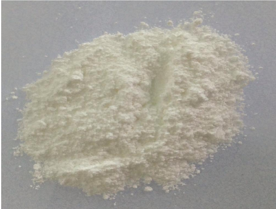
รูปที่ 3.4 ลักษณะของผง \text{TiO}_2 จากการสังเคราะห์ด้วยกระบวนการกลั่นไหลกลับ
