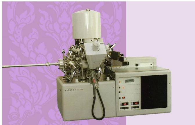
ภาพที่ 2.13 เครื่องวิเคราะห์ผิววัสดุ (X-ray Photoelectron Spectroscopy, XPS) [34]
