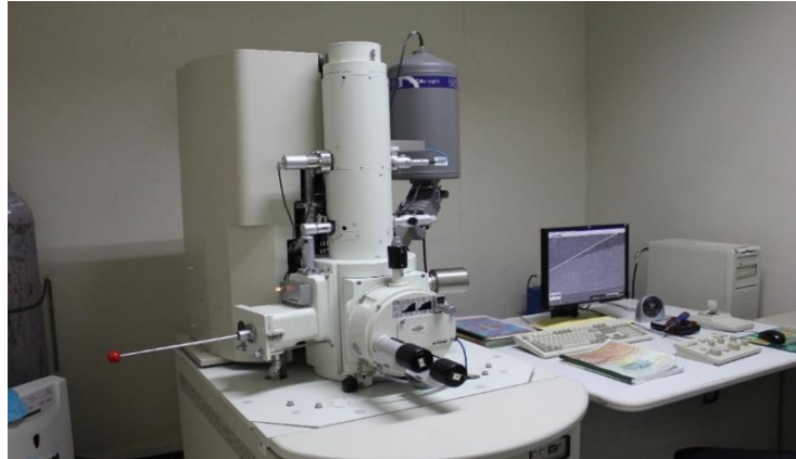
ภาพที่ 3.2 กล้องจุลทรรศน์อิเล็กตรอนแบบส่องกราด (Scanning Electron Microscope, SEM)
