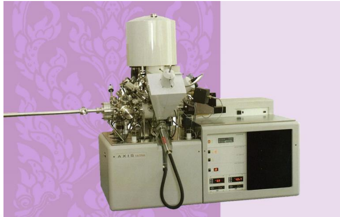
ภาพที่ 3.3 เครื่องวิเคราะห์ผิววัสดุ (X-ray Photoelectron Spectroscopy, XPS)
