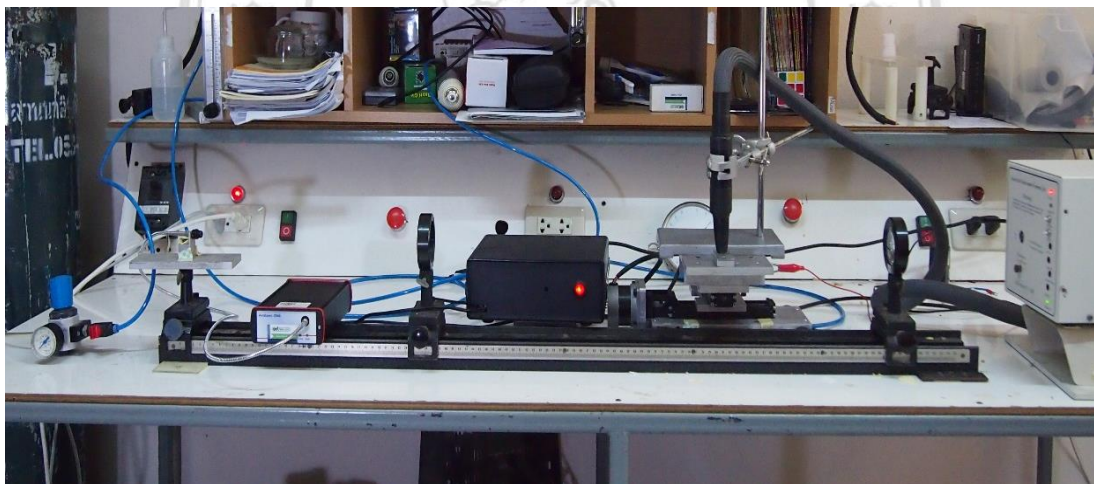
รูปที่ 3.2 แสดงการจัดเรียงอุปกรณ์จริงสำหรับวัดความหนาแน่นของอนุมูลในพลาสมาโดยใช้สเปกโตรสโคปีแบบดูดกลืนยูวี
