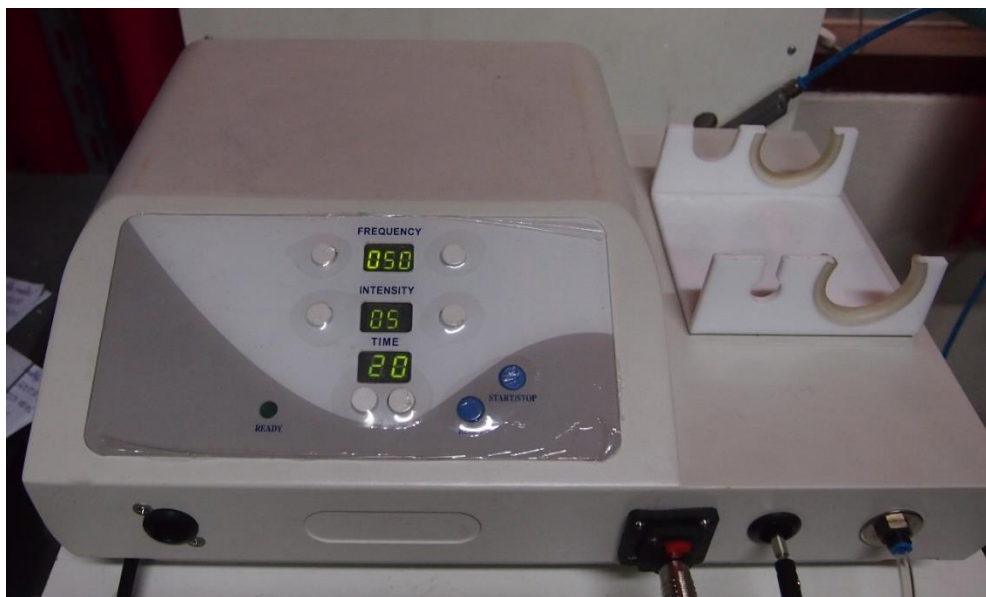
รูปที่ 3.7 อุปกรณ์จ่ายไฟของระบบ Hybrid Jet-Floating electrode plasma system
