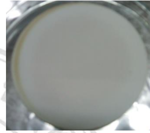
ภาพที่ 3.3 แสดงวัสดุเป้าไฮดรอกซีอะพาไทต์
