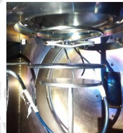
ภาพที่ 3.9 แสดงท่อปล่อยก๊าซแบบห่วงในอุโมงค์
