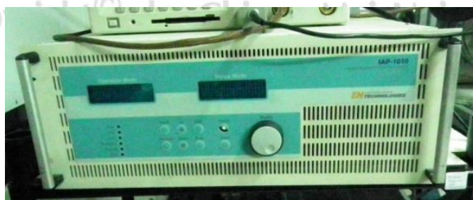
ภาพที่ 3.4 แสดงแหล่งจ่ายไฟกระแสตรงแบบเป็นห้วง รุ่น IAP 1010
