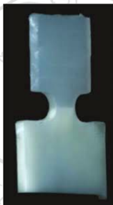
รูปที่ 3.12 แสดงชิ้นงานที่ได้รับการตัดแต่งเป็นรูปนาฬิกาทราย
