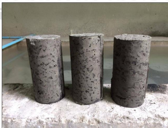
รูปที่ 3.24 คอนกรีตทรงกระบอกที่แข็งตัวแล้ว
