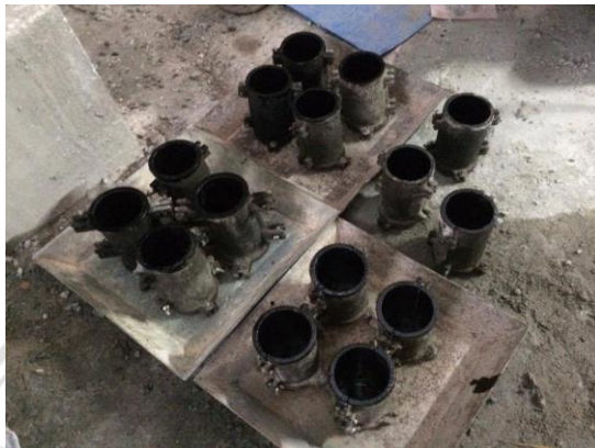
รูปที่ 3.22 แบบหล่อขนาดเส้นผ่าศูนย์กลาง 10 cm สูง 20 cm ที่ใช้
