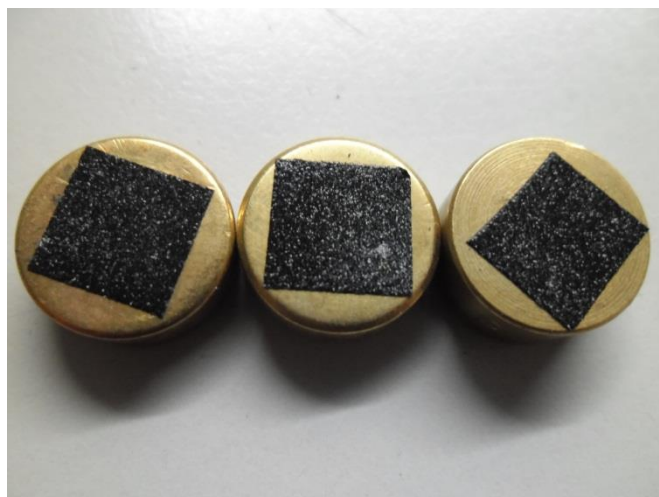
รูปที่ 3.3 แท่ง Stub ที่โรยผงเคลือบชีวมวล
