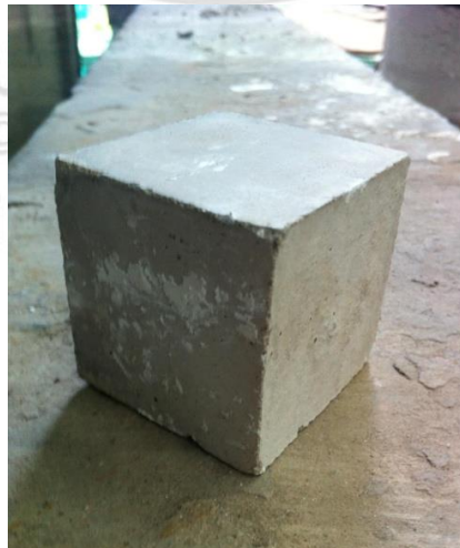
รูปที่ 3.13 มอร์ตาร์ที่บ่มและอายุ 28 วัน ก่อนนำไปทดสอบกำลังอัด
