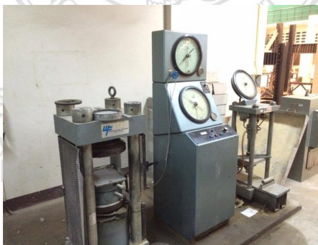
รูปที่ 3.25 เครื่องทดสอบกำลังอัดก้อนคอนกรีต
