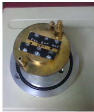
รูปที่ 3.4 ภาพระหว่างการฉายรังสีลงบนแผ่นตัวอย่าง
