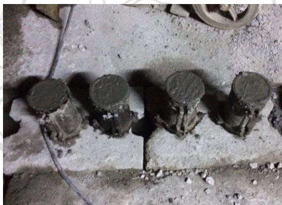
รูปที่ 3.23 คอนกรีตที่เต็มแบบหล่อทรงกระบอกเรียบร้อยแล้ว
