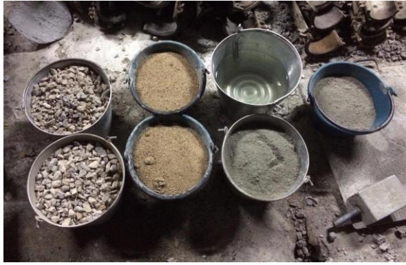
รูปที่ 3.17 ส่วนผสมของคอนกรีตที่ชั่งตวงเตรียมไว้
