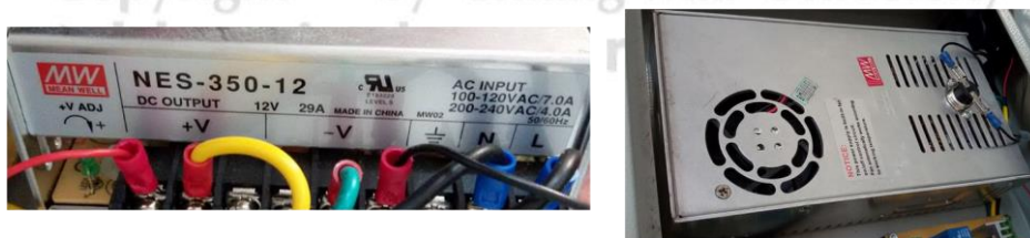
รูปที่ 4.15 สวิตซ์ชิงเพาเวอร์ซัพพลาย
