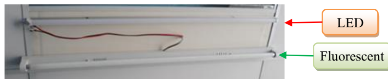
รูปที่ 5.1 การติดตั้งหลอดไฟในการทดลอง
