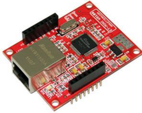
ภาพที่ 2.12 โมดูล ET-MINI W5100 มีชั้นโปรโตคอล TCP/IP ภายในตัว
