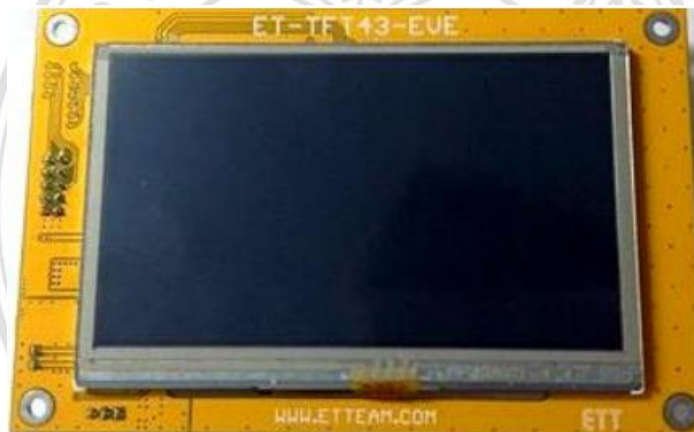
ภาพที่ 2.13 โมดูล ET-TFT43-EVE หน้าจอแอลซีดีพร้อมหน้าจอสัมผัส
