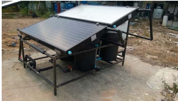
รูปที่ 3.12 โมดูลชนิดมีกระจกปิดทับบน (ด้านบน) และไม่มีกระจกปิดทับบน(ด้านล่าง)
