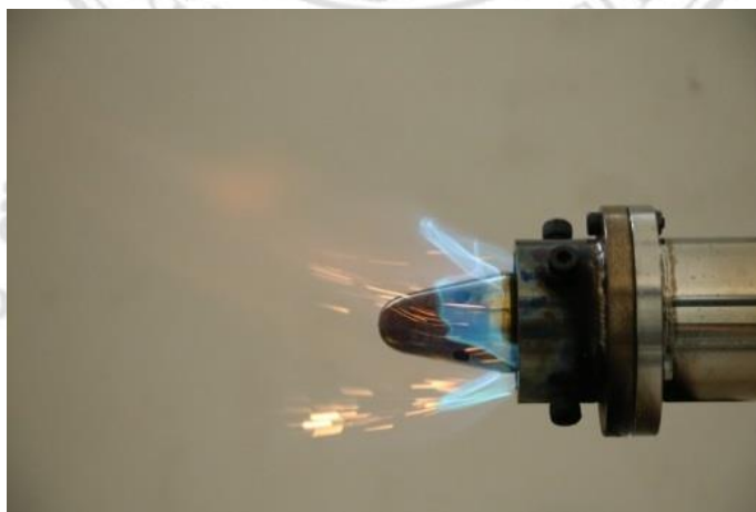
รูป จ.3 : เปลวไฟที่มีหยดน้ำมัน ที่เงื่อนไขทดสอบ
