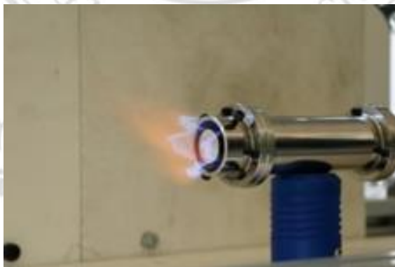
รูปที่ 4.14 ตัวอย่างผลทดสอบหัวเผาแบบที่ 5.1 ความยาวท่อระยะ 30 cm.
