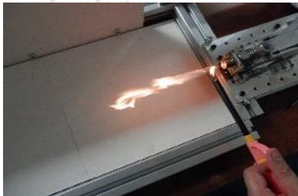
รูปที่ 4.3 แสดงตัวอย่างผลทดสอบหัวเผา 1 ที่เส้นผ่านศูนย์กลางหัวเผาขนาด 1.0 mm
