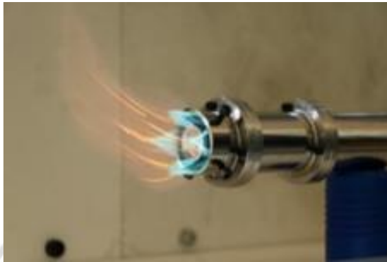
รูปที่ 4.13 ตัวอย่างผลทดสอบหัวเผาแบบที่ 5.1 ความยาวท่อระยะ 35 cm.
