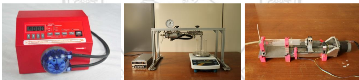
รูปที่ 4.1 ส่วนจ่ายเชื้อเพลิงที่ออกแบบทั้ง 3 ระบบ
