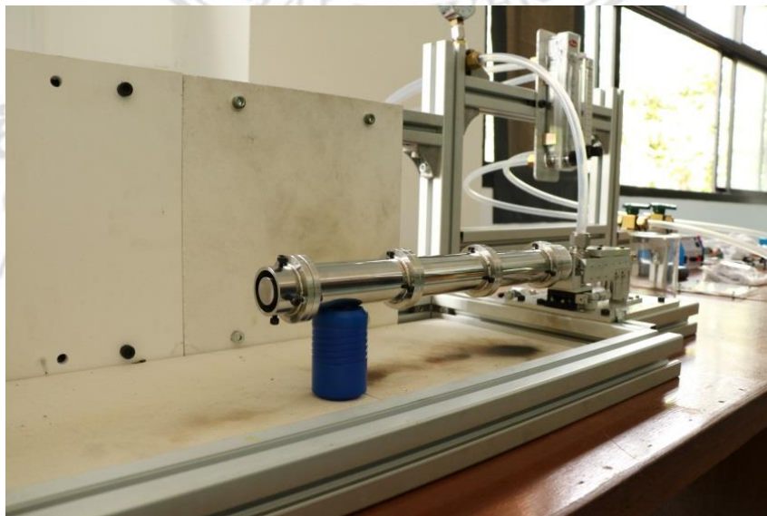
รูปที่ 5.1 หัวเผาแบบที่ 5.1 สำหรับทดสอบหาขนาดเส้นผ่านศูนย์กลางเฉลี่ยของละอองน้ำมัน (MMD)
