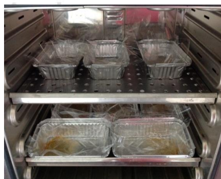
ภาพที่ ค-8 ทำให้สารละลายเจลาตินแห้งด้วยเครื่องอบลมร้อน
