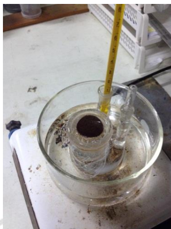
รูป 3.11 การวางขึ้นทดสอบสำหรับการทดสอบความสามารถในการปลดปล่อยยา
