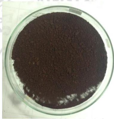
รูป 3.1 ลักษณะของพอลิทีโอฟินที่สังเคราะห์ได้
