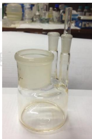
รูป 3.10 อุปกรณ์ทดสอบความสามารถในการปลดปล่อยยา
