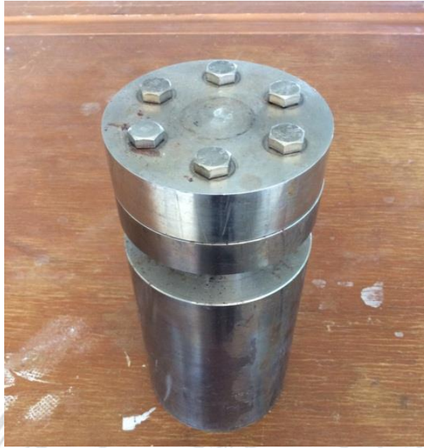
รูปที่ 2.3 บอมบ์หรือออตเคลฟใส่สารในการสังเคราะห์วิธีไฮโดรเทอร์มอล
