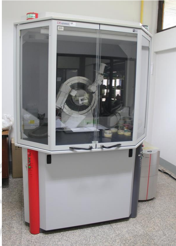
รูปที่ 3.4 เครื่องวิเคราะห์การเลี้ยวเบนของรังสีเอ็กซ์
