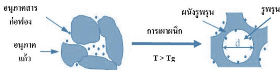
ภาพที่ 10 กระบวนการเกิดรูพรุนของแก้ว (กำหนดให้ T = อุณหภูมิเผาศึก และ T_g = อุณหภูมิ เปลี่ยนแปลงสภาพแก้ว)
