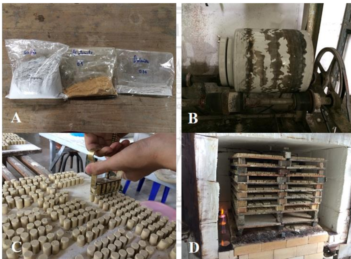
ภาพที่ 11 การผลิตวัสดุแก้วพูนแบบลอยน้ำ A) วัตถุดิบในการผลิตแก้วพูน B) ถังเซรามิกสำหรับผสมวัตถุดิบ C) การขึ้นรูปแก้วพูนด้วยแบบพิมพ์ D) การเผาแก้วพูนในเตาเผาแก๊ส
