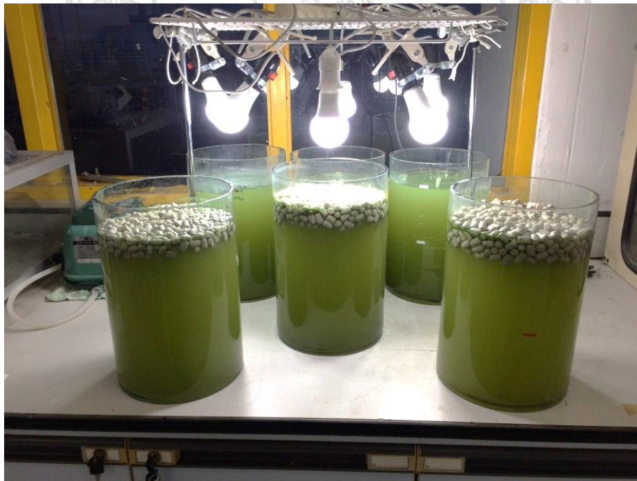
ภาพที่ 12 การทดสอบประสิทธิภาพของ Bacillus sp. AK3 ที่ตรึงบนวัสดุแก้วพูนแบบลอยน้ำ ในการควบคุม Microcystis spp. และย่อยสลายไมโครซิสตินจากธรรมชาติ ในคอลัมน์แก้วปริมาตร 10 ลิตร
