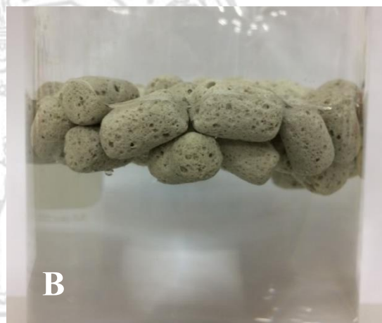
ภาพที่ 24 วัสดุแก้วพูนแบบลอยน้ำที่ผลิตได้ในห้องปฏิบัติการ A) ลักษณะรูปร่างของแก้วพูนแบบลอยน้ำ และ B) ลักษณะการลอยน้ำของวัสดุแก้วพูน
