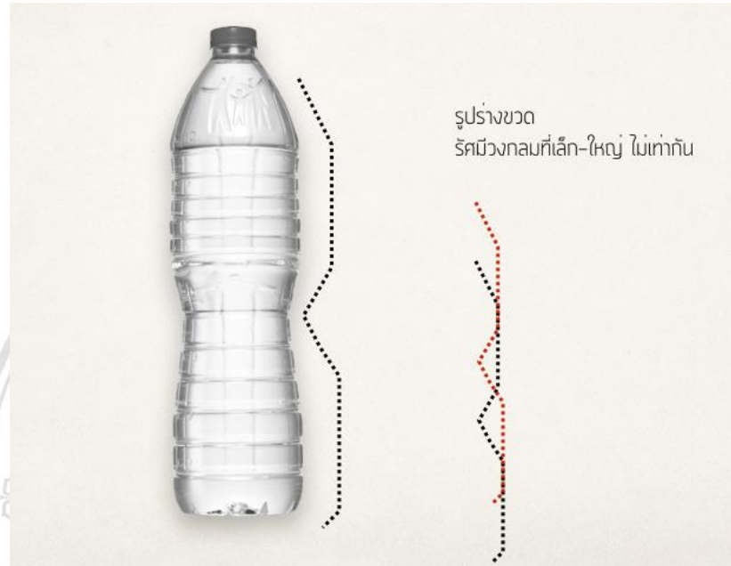
ภาพที่ 2.17 เทคนิค Interlock เชื่อมต่อขวดโดยใช้ร่องหยักเป็นตัวล็อก
